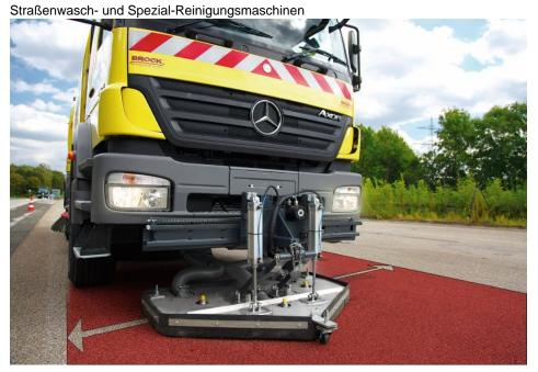
Die Ölspurbeseitigungseinheit lässt sich an alle Kehrfahrzeugen anbauen. Über die Parallellaufschiene ist eine Reinigung auf der kompletten Fahrzeugbreite möglich (Bild: Brock Kehrtechnik).
