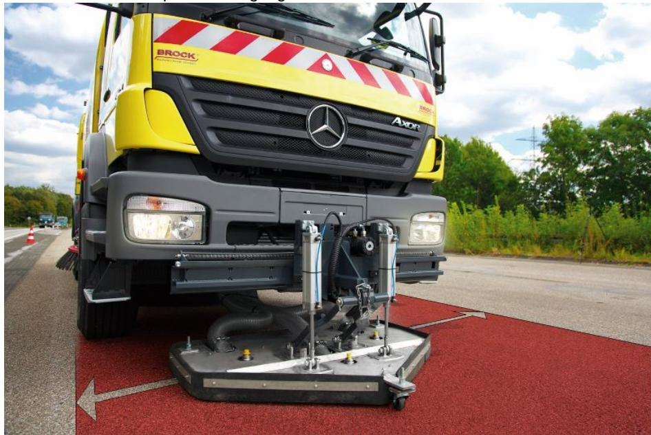
Die Ölspurbeseitigungseinheit lässt sich an alle Kehrfahrzeugen anbauen. Über die Parallelalaufschiene ist eine Reinigung auf der kompletten Fahrzeugsbreite möglich (Bild: Brock Kehrtechnik).
