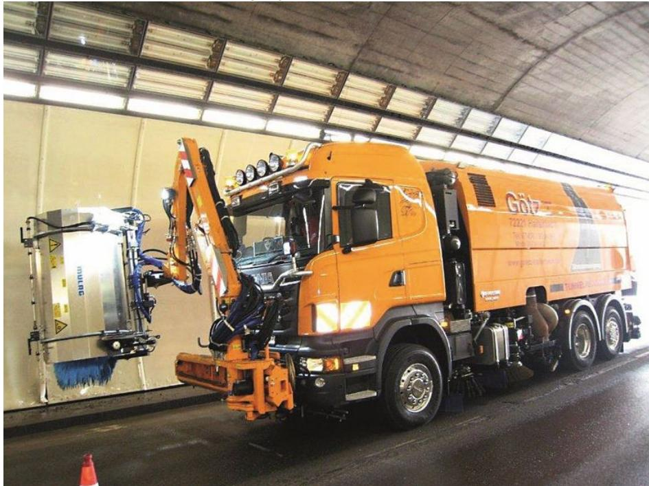
Mit ihrer beheizbaren Hochdruck-Sprühhanlage ist die VIAJET12 AQUATERM ein Spezialist für Fräsguteinsätze, die Ölspurbeseitigung sowie die Reinigung von Tunnelwänden (Bild: Faun).
