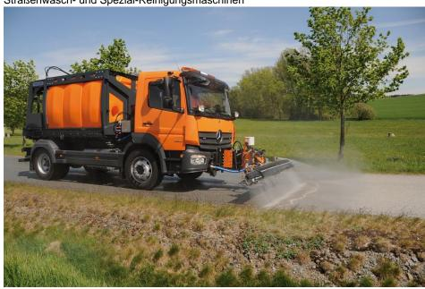
Die Wassertanktechnik, hier z. B. der Schwemmbalken »FSB 2500« in Verbindung mit dem variabel konfigurierbaren Tanksystem »FTS«, ist vielseitig einsetzbar (Bild: Fiedler).
