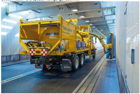
Tunnelwaschen im Großformat und unabhängig vom Lkw-Trägerfahrzeug mit dem »TWG 600-K« Kit-Tunnelwascher von Mulag (Bild: Mulag).
