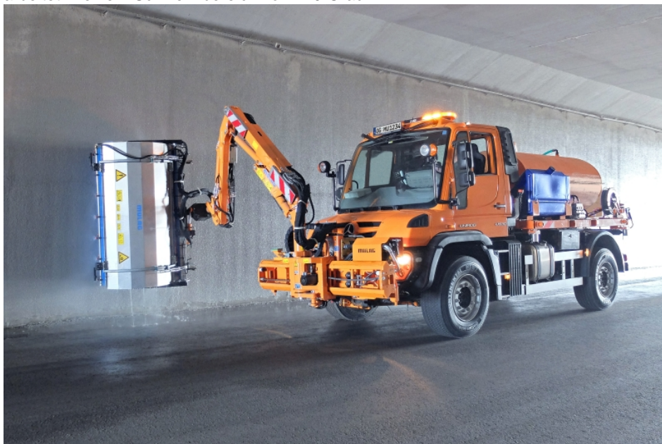
Eine Reinigung mit dem bewährten Tunnelwaschgerät »MFK 500-T« im Frontanbau (Bild: Mulag).
