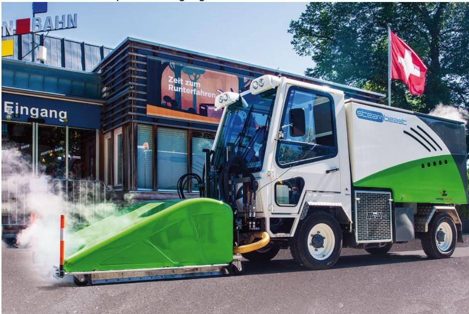
Das Reinigungsverfahren des »Steambeast« ist ein sehr lärmärmer thermo-mechanischer Prozess (Bild: Zaugg).
