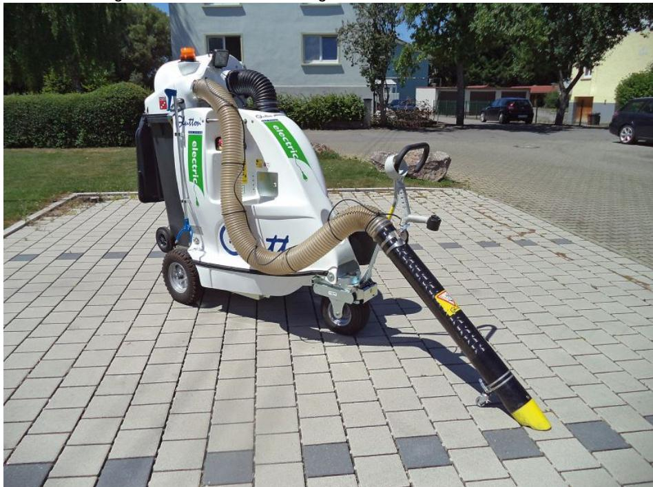
Der selbstfahrende mit Strom betriebene Glutton-Stadtmüllsauger verfügt über eine Batteriekapazität von 8 bis 16 Stunden (Bild: Bertsche).
