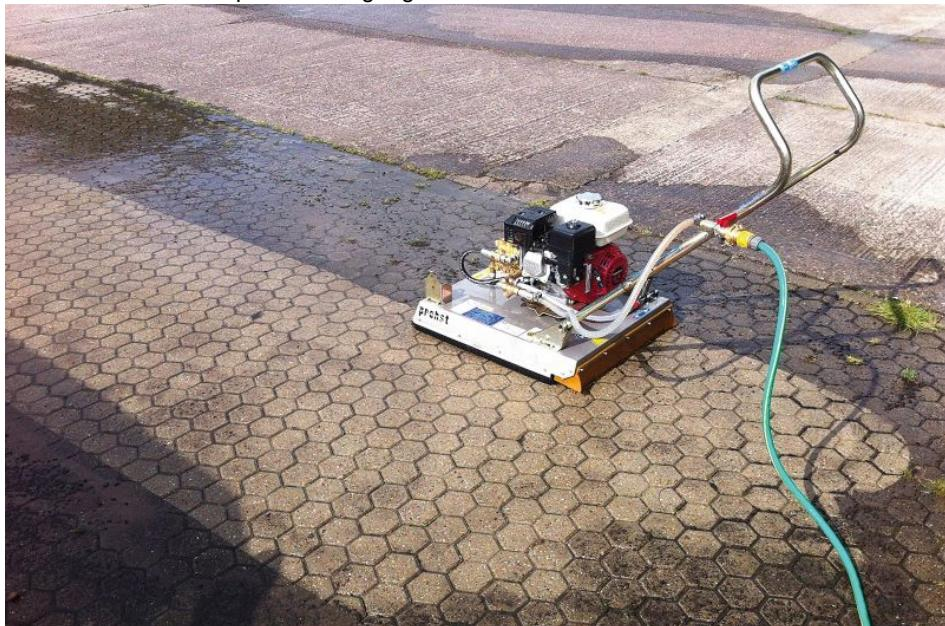
Zwei rotierende Sprühdüsen des Easyclean 60 reinigen die Oberfläche und spülen die verunreinigten Fugen aus (Bild: Probst).
