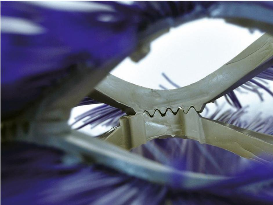
Markante Zacken auf dem Bürstenträger verhindern, dass sich die Ringe verschieben (Bild: Weber).
