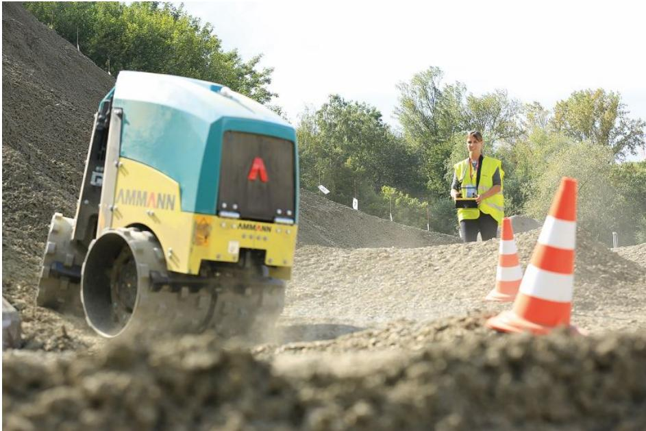
Das Knick-/Pendelgelenk sorgt dafür, dass auf unterschiedlichsten Materialien und Böden die Walze immer gleichmäßigen Kontakt zum Untergrund hat (Bild: Ammann).
