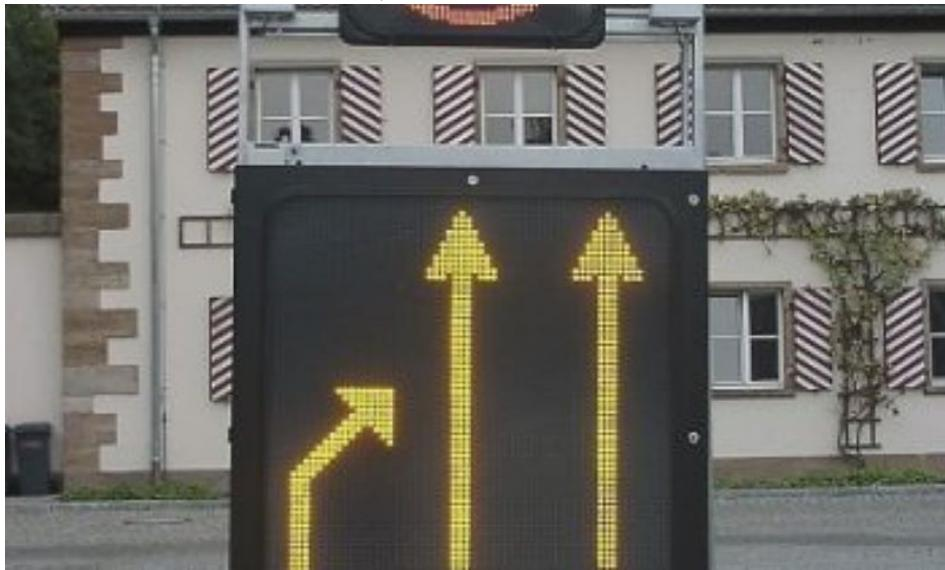
Vorwarnanhänger in LED-Technik und mit CB-Funkanlage warnen Lkw vor der Gefahrenstelle (Bild: B&E antec).
