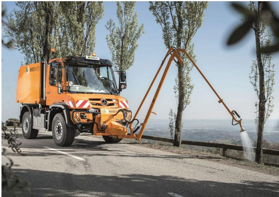
Den Gießarm von Eco Technologies gibt es für verschiedene Trägerfahrzeuge. Der Wassertank befindet sich entweder auf einer Pritsche oder wird per Dreipunktanbau am Heck befestigt (Bild: Eco Technologies).
