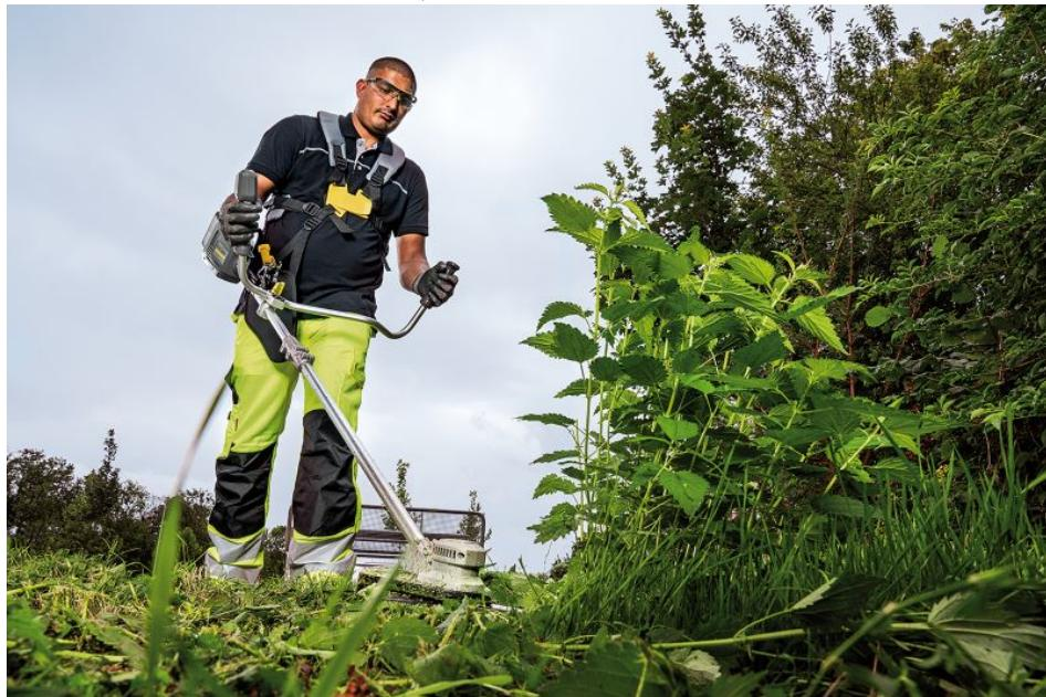
Für schwer erreichbare Stellen im Profi-Arbeitseinsatz kommen die Kärcher Akku-Freischneider mit zweiarmigem Fahrradgriff und Hüfthalterung sowie Stahlmesser zum Einsatz (Bild: Kärcher).
