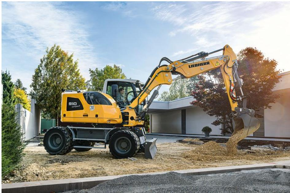
Auch bei engsten Platzverhältnissen zeichnen sich die Liebherr-Compact-Mobilbagger dank ihres geringen Heckschwenkradius mit hoher Produktivität und Leistungsfähigkeit aus (Bild: Liebherr).
