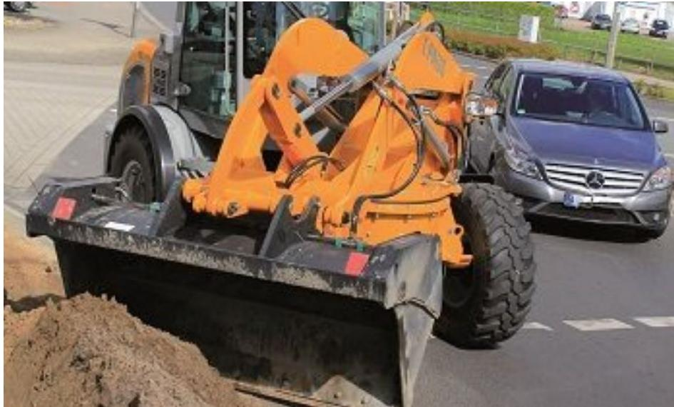
Der Rad-Schwenklader RL 7 von Paus belegt in Verkehrsbaustellen lediglich eine Spur (Bild: Paus).
