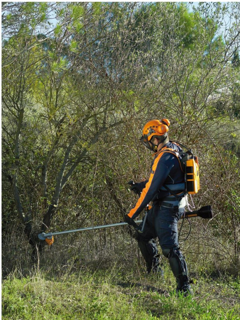
Die Motorsense »Excelion Alpha« kann neben einem Rückentrage-Akku auch wahlweise per Akku »Alpa 520« mit Energie versorgt werden (Bild: Pellenc).
