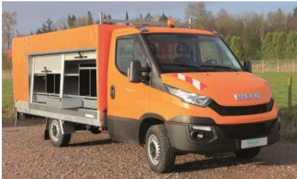
Tief- und Straßenbaufahrzeug für Ordnung und Sicherheit in einem – die Schoon Tiefpritsche mit integrierten Werkzeugkisten (Bild: Schoon).
