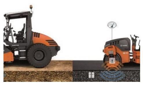
Den Hamm Compaction Meter (HCM) für die Verdichtungsmessung gibt es für die Walzenzüge H 5i und H 7i sowie für alle Kompaktwalzen der HD CompactLine ab 2 t Gewicht (Bild: Hamm).
