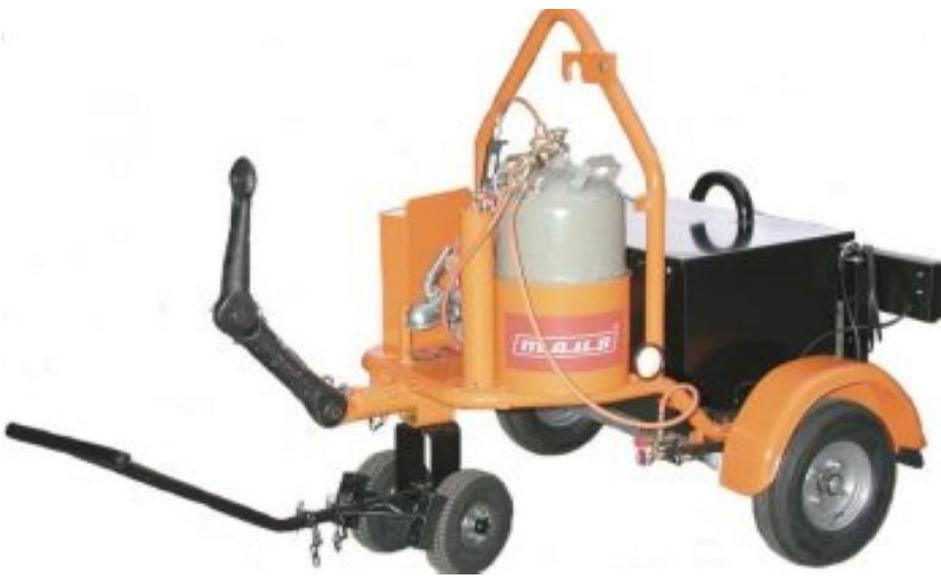
Die Mischgut-Behältermaschine Typ »89A/13-00« von Maus ist dafür geeignet, kalteinbaufähiges Asphaltmischgut zu transportieren und aufzuheizen (Bild: Maus).
