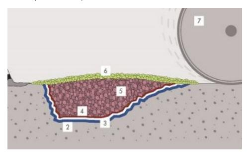
Die Schadstelle wird: 1. bewertet und markiert, 2. mit Wasser gereinigt, 3. mit Luft trocken geblasen, 4. mit Bindemittel angespritzt, um eine Haftbrücke herzustellen, 5. mit bitumenhaltiger Mischung ausgefüllt – bei tiefen Stellen mit 4 – 6 oder 2 – 10 mm, 6. eine Deckschicht mit 2 – 4 mm bitumenhaltiger Mischung aufgebracht, 7. durch den Straßenverkehr verdichtet, zusätzliche Verdichtung mit einer Walze/Gummirad, weitere Reduzierung des Rollsplitts (Bild: schäfer-technic).
