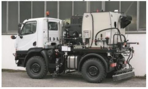
Spezialisiert auf die Naht- und Randanspritzung von Fahrbahnbelägen ist die Spritzmaschine »HK 1000 PH« (Bild: Weisig).
