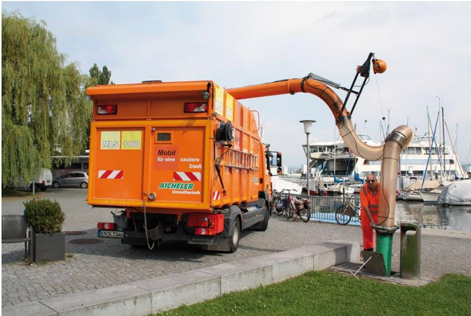
Mittels langem Ausleger und pneumatisch höhenverstellbarem Saugrüssel lässt sich mit dem Müll-/Laubsauger auch problemlos über Hindernisse hinweg arbeiten (Bild: Aicheler).
