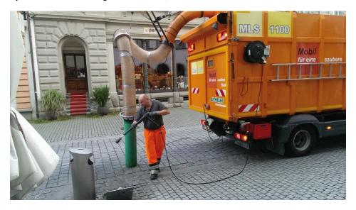
Nach dem Absaugen des unterirdischen Sammelbehälters wird mit der Hochdrucklanze die Einwurfröhre gründlich gereinigt (Bild: Aicheler).
