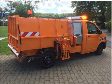
Ein Leichtmüllverdichter auf einem VW-Transporter mit Sonderzwischenbehälter und Behelfsschüttung (Bild: Bertsche).
