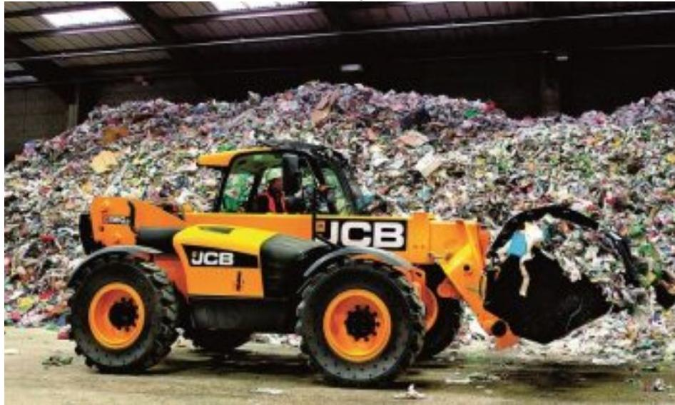
Der JCB 560-80 »Wastemaster« ist ein Hochleistungslader mit 6 t Tragfähigkeit. Er wurde speziell für Einsätze in der Abfall-/Recyclingindustrie konstruiert (Bild: JCB).
