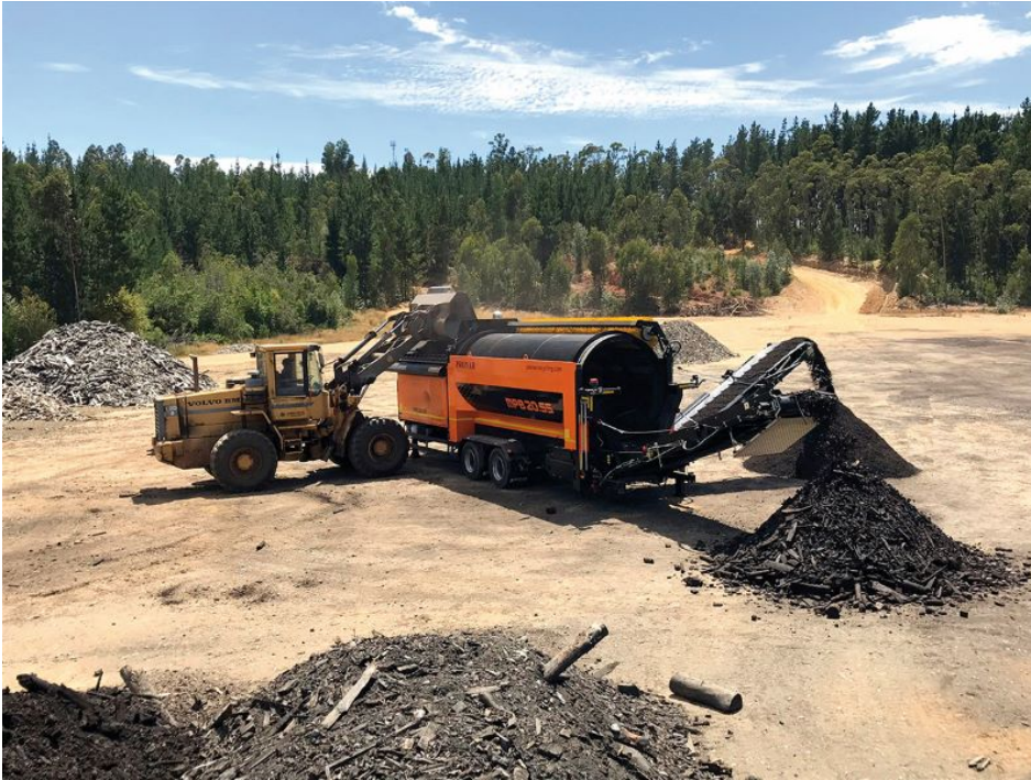
Pronar Trommelsieb »MPB 20.55« mit Zentralschmieranlage und regelbarer Bandgeschwindigkeit (Bild: Jürgen Kölsch GmbH).
