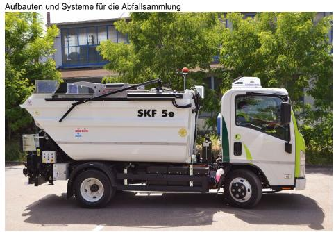
Der vollelektrische Mini-Abfallsammler SKF 5e – hier auf Isuzu-Fahrgestell – wird häufig zur Papierkorbentleerung in Park- und Grünanlagen eingesetzt (Bild: Schmidt Kommunalfahrzeuge).
