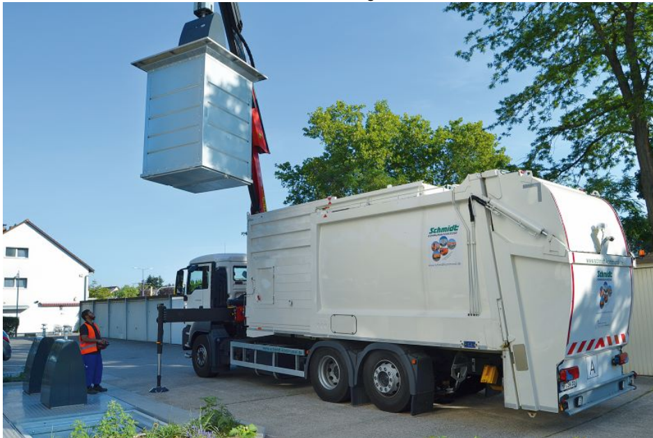
Ein »Hades«-System von Schmidt Kommunalfahrzeuge GmbH. Der SKF entsorgt per Ladekran den Inhalt vom Unterflurbehälter (Bild: Schmidt Kommunalfahrzeuge).
