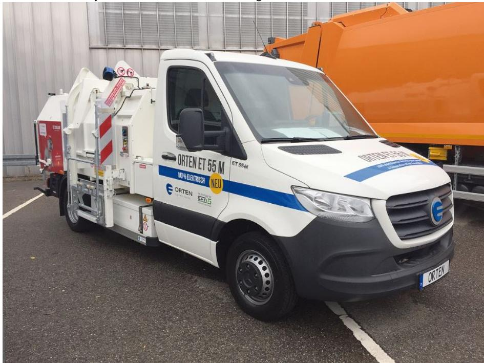
Zur Messe NUFAM präsentierte die Zoeller Gruppe den kleinen Micro HG erstmals auf einem vollektrischen Fahrgestell. Der Micro HG-Aufbau ist in Größen von 2,5 bis 6 m<sup>3</sup> verfügbar (Bild Zöller-Kipper).
