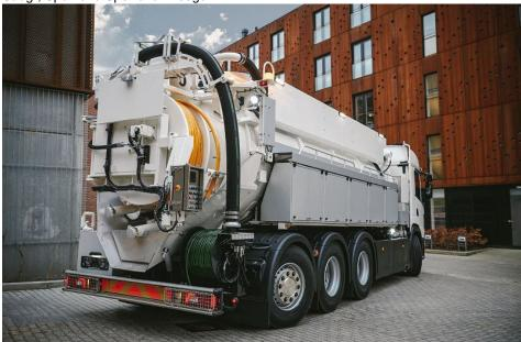
Ein FlexLine 414 Kanalreinigungsfahrzeug von Bucher Municipal. Das Saug- und Spühlfahrzeug besitzt eine pneumatisch verschiebbare Trennwand (Bild: Bucher Municipal).
