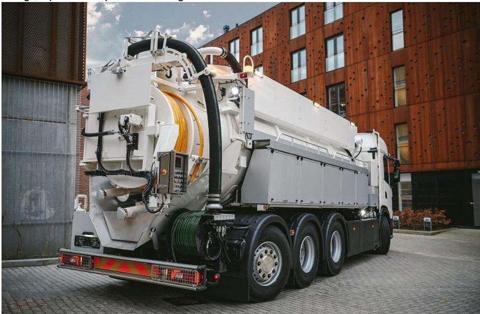
Ein FlexLine 414 Kanalreinigungsfahrzeug von Bucher Municipal. Das Saug- und Spülfahrzeug besitzt eine pneumatisch verschiebbare Trennwand (Bild: Bucher Municipal).
