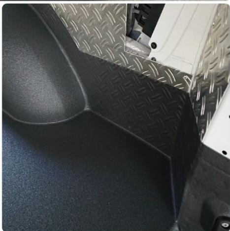
Ein wichtiges Detail eines Spülfahrzeugs – die Beschichtung des Bodens. Diese macht den Laderraum robust und wasserdicht (Bilder: KCN).
