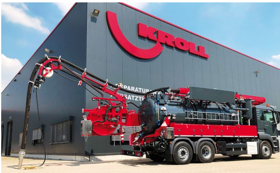
Saug-Spülfahrzeug mit Kroll Wasserrückgewinnung und Simultanausleger (Bild: Kroll).
