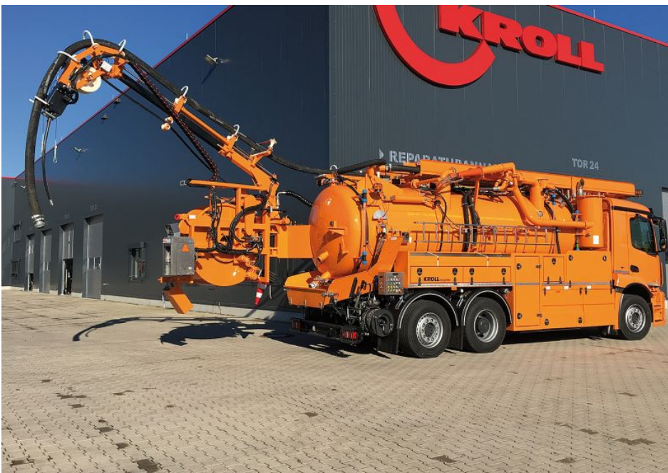
Saug- und Spülfahrzeug mit ADR-Ausstattung und Teleskopausleger (Bild: Kroll).
