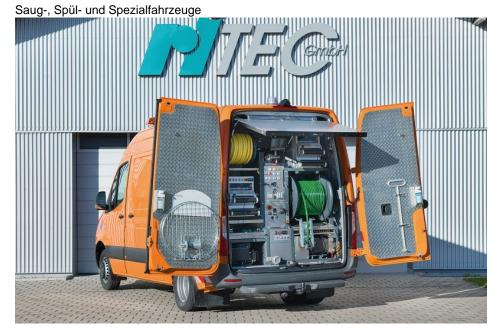
Ausbaubeispiel Mercedes Sprinter als TV-Inspektionsfahrzeug mit Hochdruck-Spüleinheit (Bild: Ritec).
