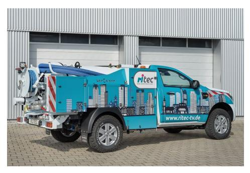
Ein tiefgaragentaugliches Saug- und Spülfahrzeug Hydrocity mit insgesamt 1200 I Tankvolumen (Bild: Ritec).
