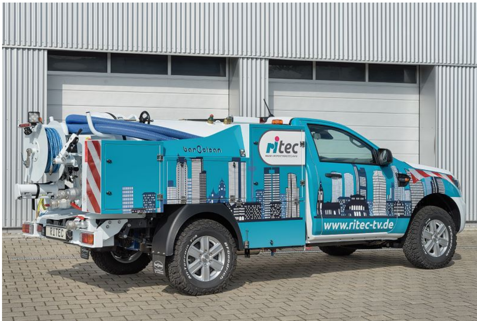
Ein tiefgaragentaugliches Saug- und Spülfahrzeug Hydrocity mit insgesamt 1200 l Tankvolumen (Bild: Ritec).
