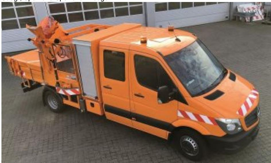
Hydraulisches Heben und Kippen der Vorrichtung ohne Kraftanstrengung. In ca. 2 Minuten ist eine Senke bei 50 m Anfahrt mithilfe des ProCleans entleert (Bild: Subtech).
