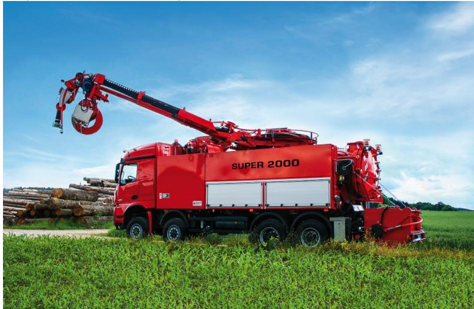
Mit seinem bis zu 270° schwenkbaren Auslegersystem »Spacer« bietet der »Super 2000« größte Beweglichkeit (Bild: Wiedemann enviro tec).
