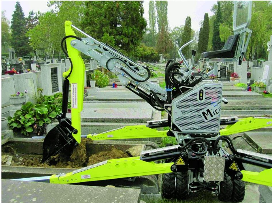
Humer Handy Micro mit permanentem Allradantrieb. Er besitzt ebenfalls ein teleskopierbares Fahrwerk mit einer minimalen Durchfahrtsbreite zur Grabstelle von 55 cm (Bild: Humer).
