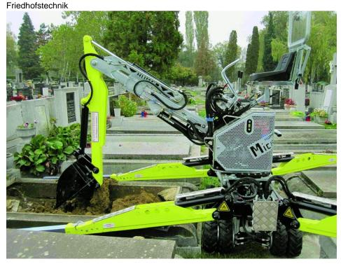
Humer Handy Micro mit permanentem Allradantrieb. Er besitzt ebenfalls ein teleskopierbares Fahrwerk mit einer minimalen Durchfahrtsbreite zur Grabstelle von 55 cm (Bild: Humer).
