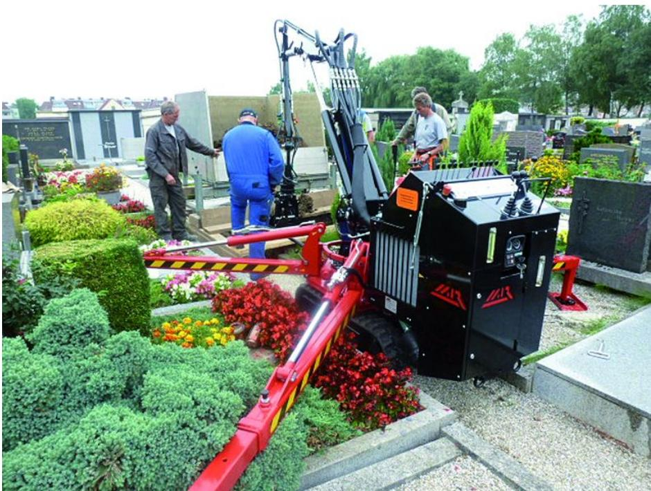
Wegen seiner schmalen Spurbreite von 60 cm und des hydraulisch verstellbaren Raupenfahrwerks ist der Friedhofsbagger nicht nur bei Steinmetzen sowie Garten- und Landschaftsbauern, sondern auch bei Bestattern sehr beliebt (Bild: Riebsamen).
