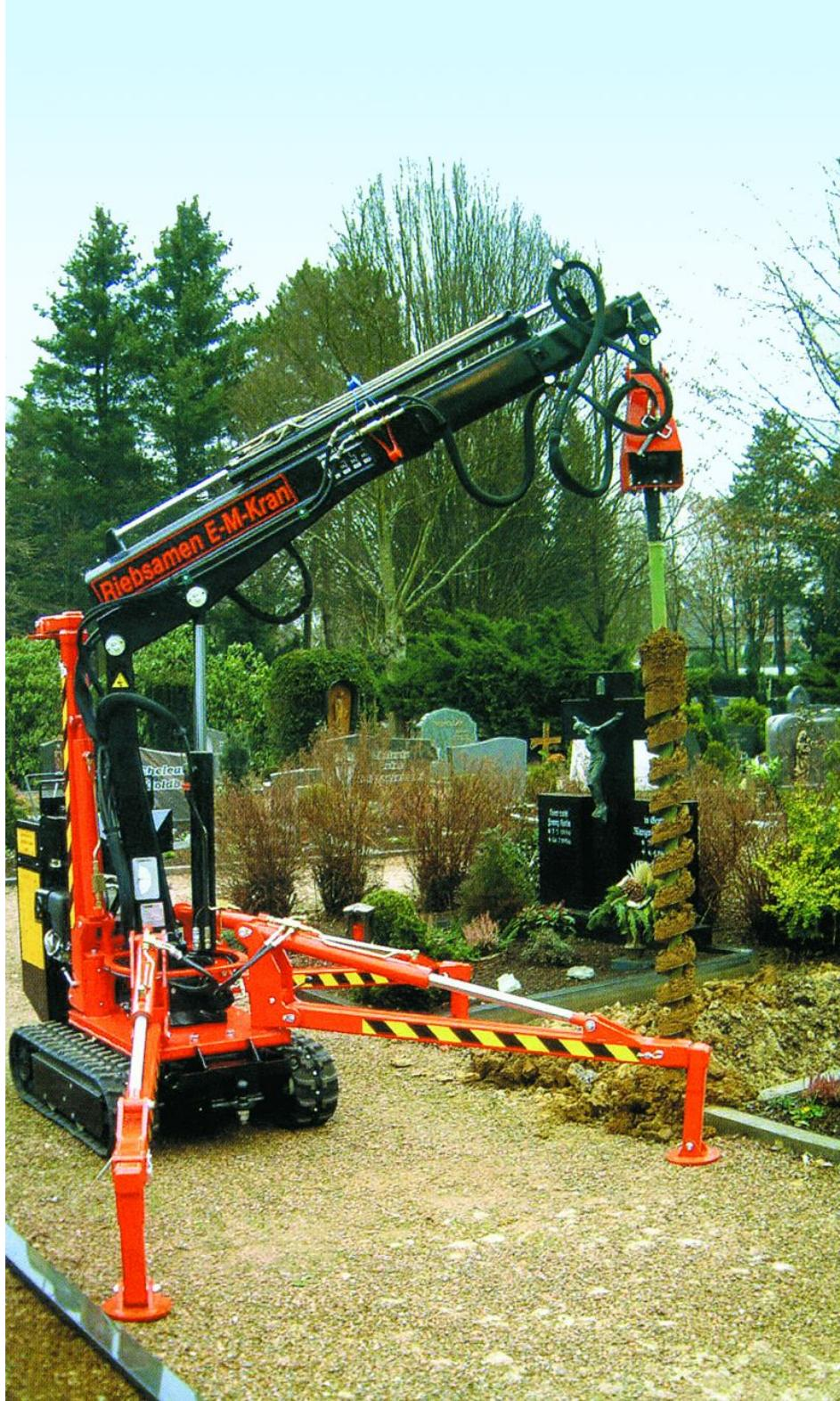
Eine praktische Option für den »Euro-Multi«-Kran ist die Montage eines Erdbohrers
