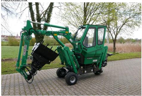
Alle handgeführten »Robo«-Bagger können optional mit einer geschlossenen Kabine ausgestattet werden (Bild. Schmelzer).
