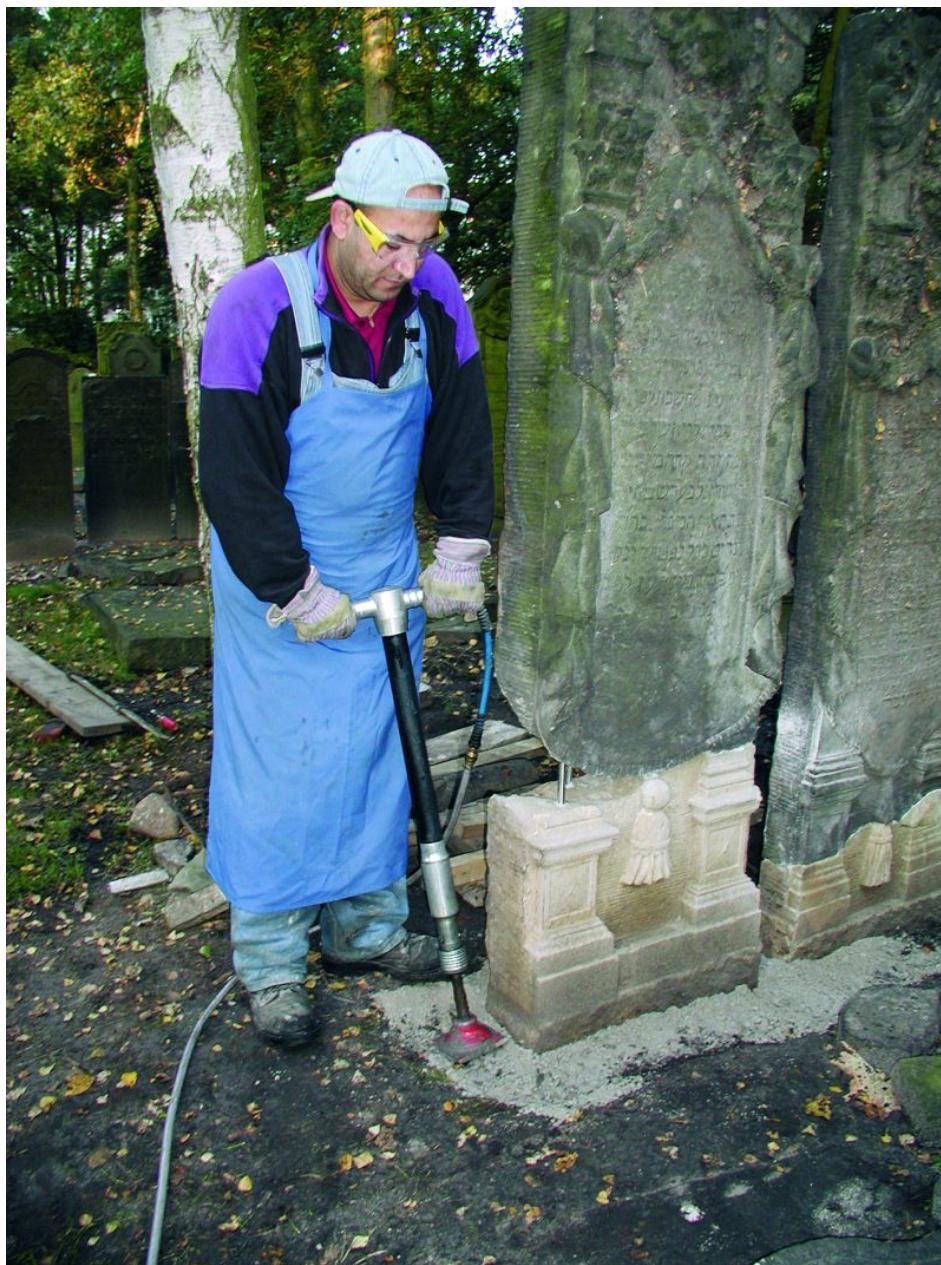
Der Druckluftspaten »Turbo VTS 50« leistet bei der Graberstellung und - wiederinstandsetzung wertvolle Dienste. Für den Spaten stehen die unterschiedlichsten Werkzeuge zur Verfügung (Bild: Vogt).
