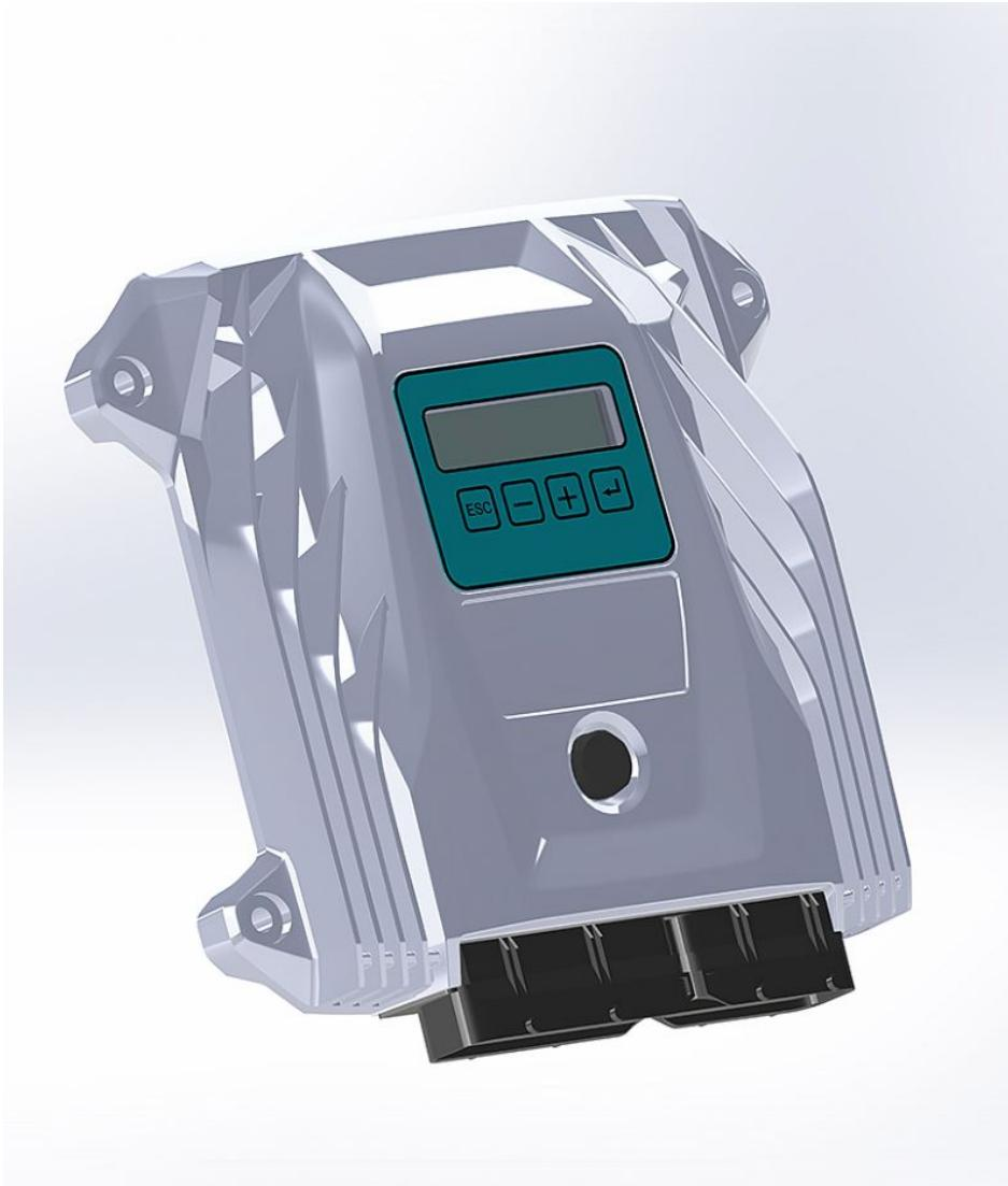
ME Mobil Elektronik entwickelt Sicherheits-Lenkcomputer in automotive-konformen Gehäusen mit der Schutzart IP6K9K für Ehla-Hilfslenksysteme (Bild: ME Mobil Elektronik).
