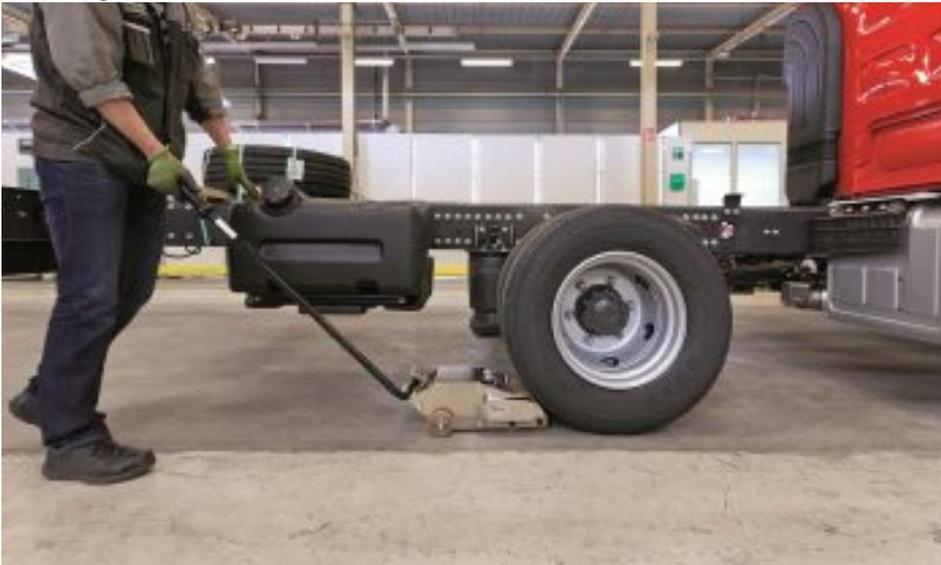
Mit dem »Easy Mover« Rollentransportgerät können Eisenbahnwaggons, Kabelrollen, Omnibusse u. v. m. von Hand bewegt werden (Bild: Fetec GmbH).
