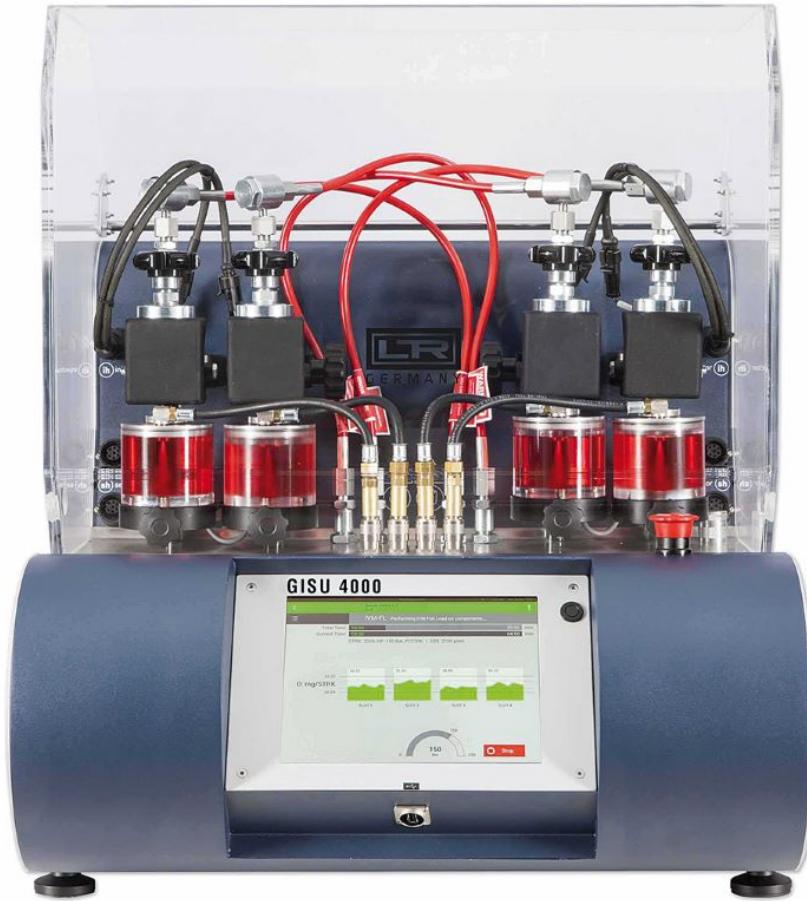
Digitales Durchfluss-Messgerät für Hydrauliköl inklusive Temperatur- und Druckmessung vom Diagnosetechnik Spezialisten Leitenberger (Bild: Leitenberger).
