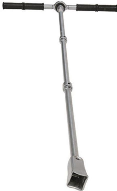
Im Bild der Schieberschlüssel und eine Universalnuss (Bild: Höpfinger).
