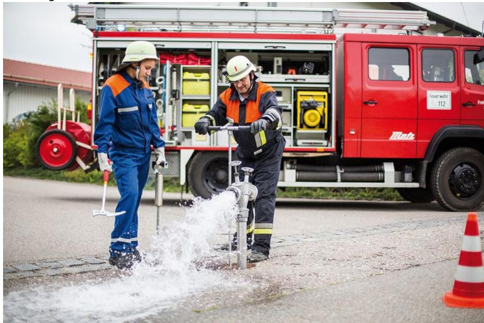
Höpfinger fertigt eine Reihe von Spezialwerkzeugen zum Öffnen und Bedienen von Straßenkappen und Schiebern (Bild: Höpfinger).
