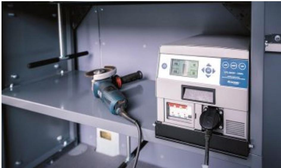
Die Lithium-Power-Supply von Leab macht aus jedem Fahrzeug ein Sonderfahrzeug mit mobiler 12- und 230-V-Stromversorgung (Bild: Leab).
