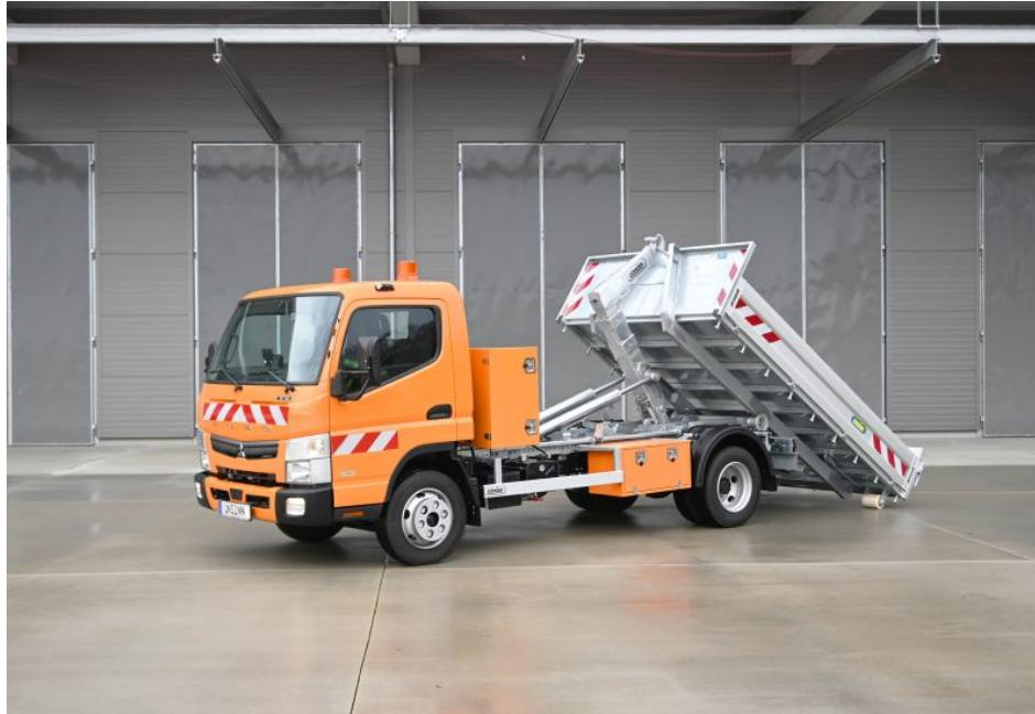
Durch den einfachen Wechsel verschiedener Abrollbehälter, von der Schüttgut- und Häckselgutmulde über den Gieß- und Laubsaugcontainer bis hin zur Salzstreuerplattform für den Winterdienst, ist man mit nur einem Fahrzeug für jeden Einsatz gerüstet.
