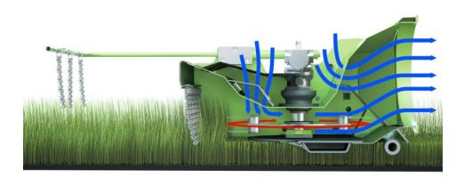
Optimierte Luftführung durch eine innovative neue Konstruktion des Mähkopfs.
