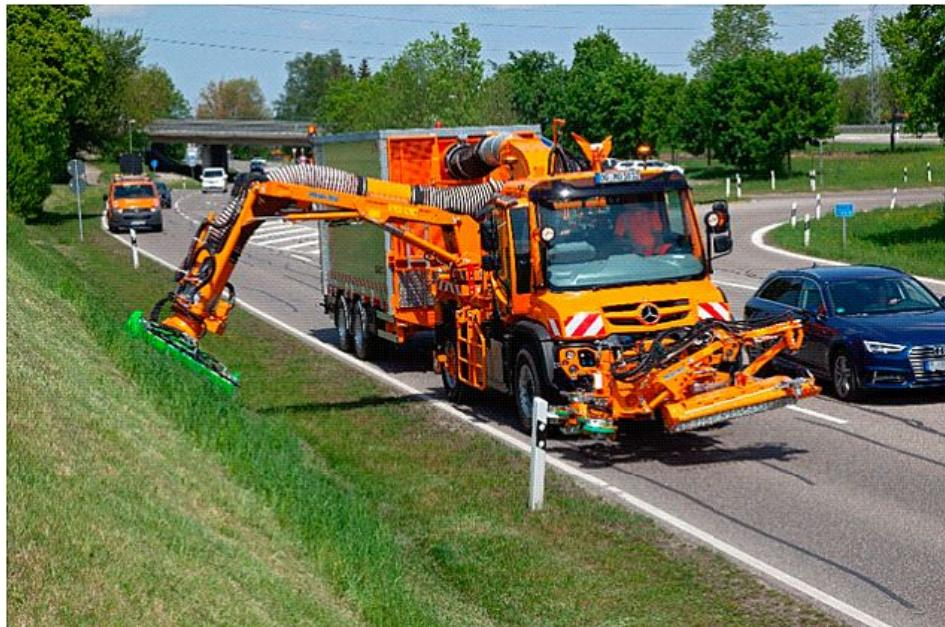
Der neue Mulag- Grünpflegekopf ECO 1200 plus im Einsatz mit einem Mähzug auf Basis Unimog U 530 mit aufnehmendem Heckausleger und angehängtem Mähgutwagen (Bilder: Mulag Fahrzeugwerk).
