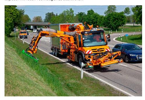
Der neue Mulag- Grünpflegekopf ECO 1200 plus im Einsatz mit einem Mähzug auf Basis Unimog U 530 mit aufnehmendem Heckausleger und angehängtem Mähgutwagen (Bilder: Mulag Fahrzeugwerk).
