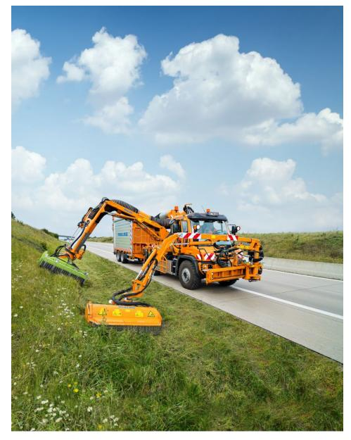
Kombinationseinsatz des Mulags-Grünpflegekopfes zum nachhaltigen Bearbeiten des Extensivsbereichs und mit herkömmlichem Schlegelmäher für den sicherheitsrelevanten Intensivbereich.
