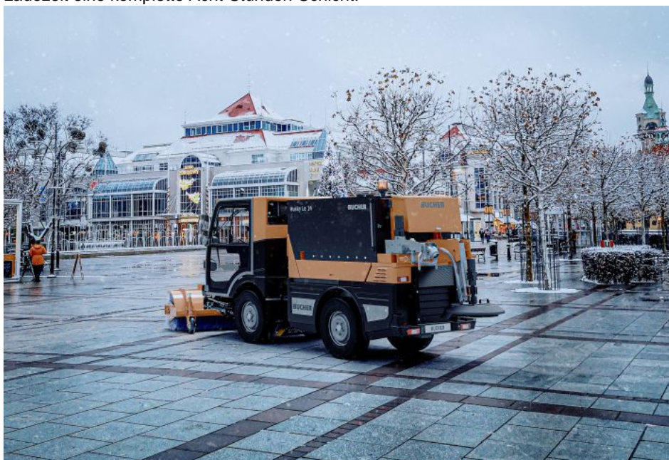
CityCat V20e in Kombination mit Kehrwalze und Solesprüher Husky Le.
