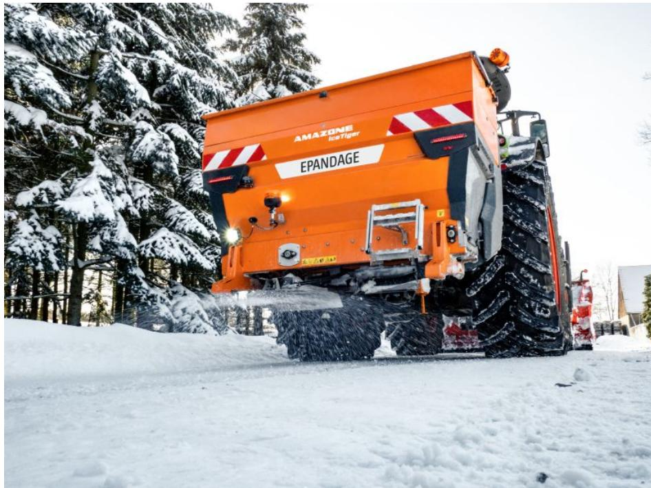
Der »IceTiger« verfügt über einen neuen Fördertechnik über einen Bandboden. Dies erlaubt die Ausbringung von Salzen mit unterschiedlichen Feuchtanteilen, selbst in Kleinstmengen, sowie abstumpfenden Materialien wie Splitt oder Sand (Bild: Amazone).
