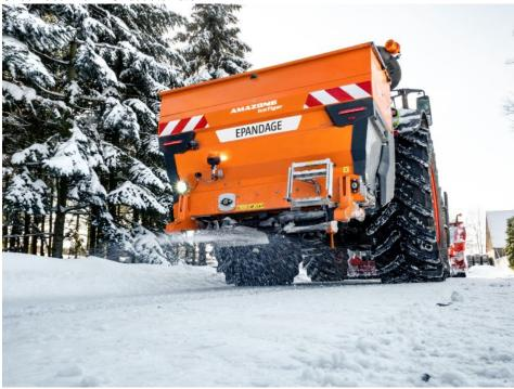
Der »IceTiger« verfügt über einen neue Fördertechnik über einen Bandboden. Dies erlaubt die Ausbringung von Salzen mit unterschiedlichen Feuchtanteilen, selbst in Kleinstmengen, sowie abstumpfenden Materialien wie Splitt oder Sand (Bild: Amazone).
